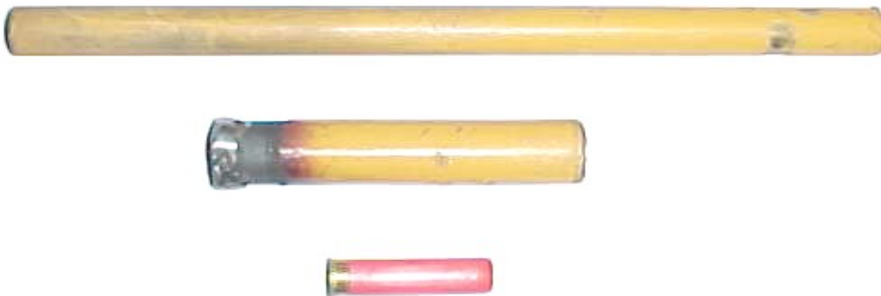
ARMA FABRICADA CON CAÑOS DE GAS EL DEL CENTRO SE OBTURO CON SOLDADURA ELÉCTRICA. DISPARA CARTUCHO CALIBRE 24 DE ESCOPETA.
