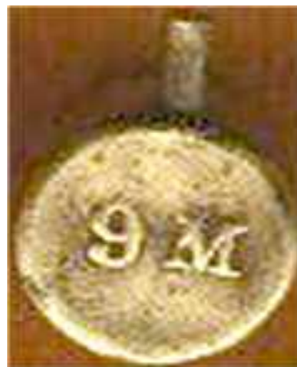
Foto 36/1 ESTAMPA CULOTE CARTUCHO A ESPIGA CALIBRE 9 MM
