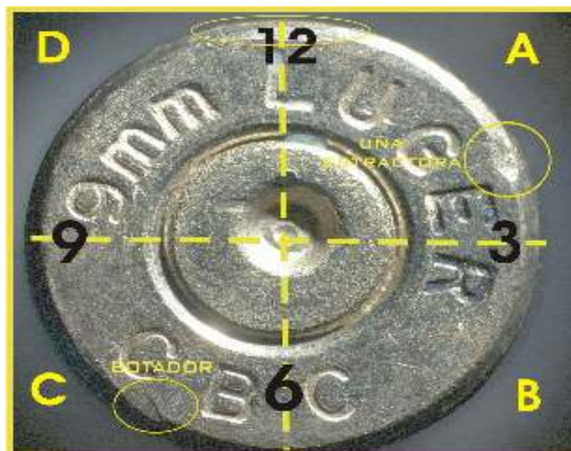
FOTO 74 LA UBICACIÓN DE HUELLAS PUEDEN VARIAR DE CUADRANTE SEGÚN EL ARMA CUADRANTE “A” EXTRACTOR CUADRANTE “C” BOTADOR
