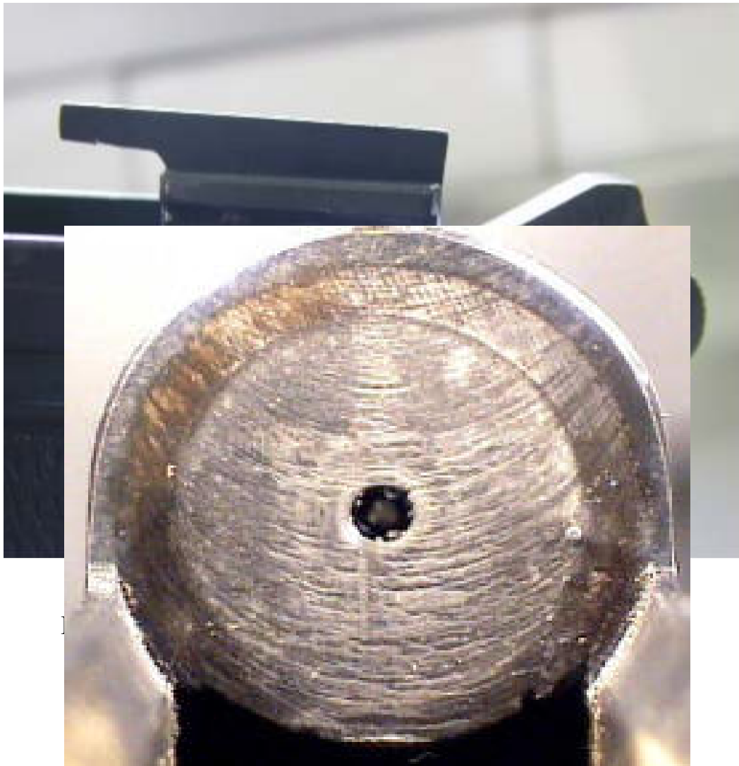
FOTO 61 ESPALDON Y ORIFICIO DEL PERCUTOR
