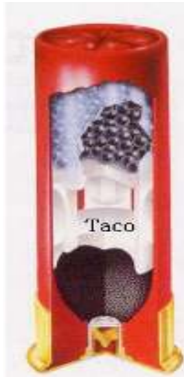
Fig. 18 Corte interno de un cartucho moderno de escopeta
