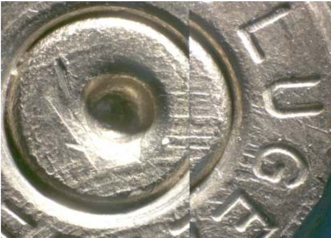
FOTO 84 COMPARACION E IDENTIFICACION DE HUELLA DEL ESPALDON
