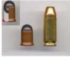
Foto 44. Munición Flobert tiro de salón y su corte interno carecen de pólvora.
