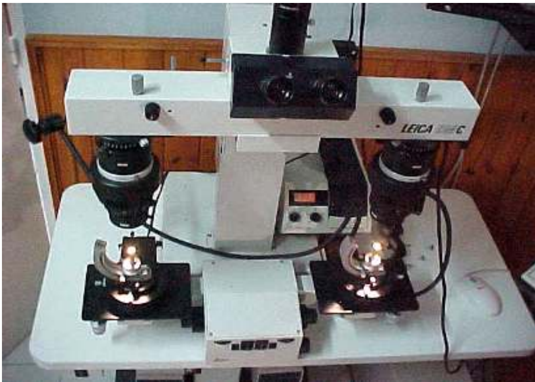
FOTO 73 MICROSCOPIO COMPARADOR MARCA LEICA
