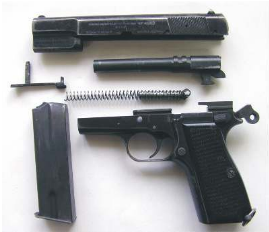
FOTO 55 DESARME PRIMARIO DE UNA PISTOLA BROWNING 9 MM
