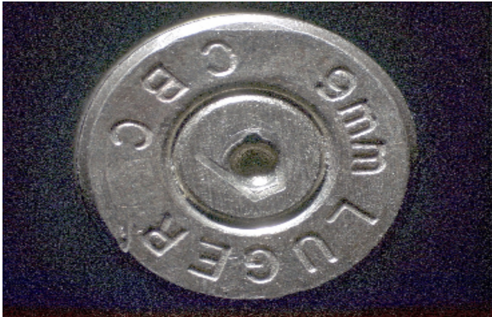
FOTO 81 HUELLAS DEL PERCUTOR. SOBRE MARCA DE LA CAPSULA FULMINANTE
