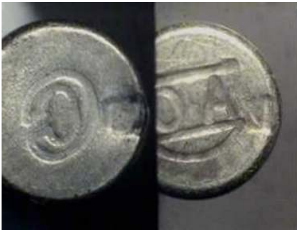
FOTO 85 HUELLAS DE PERCUTOR EN CARTUCHO DE ANULAR
