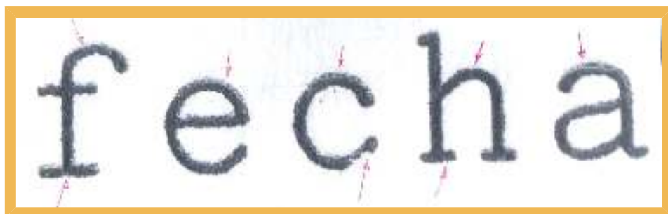
MARCACIÓN DE DEFECTOS EN IMPRESIÓN DE MÁQUINA A MARGARITA
