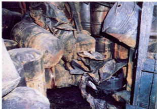
C. Tambores de 200 litros que contienen material inflamable.
