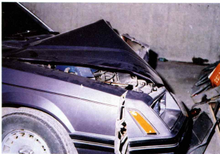
C. Costado derecho en acercamiento; se aprecia desprendimiento de la coraza y cofre, radiador y ventilador dañados más partes del motor.
