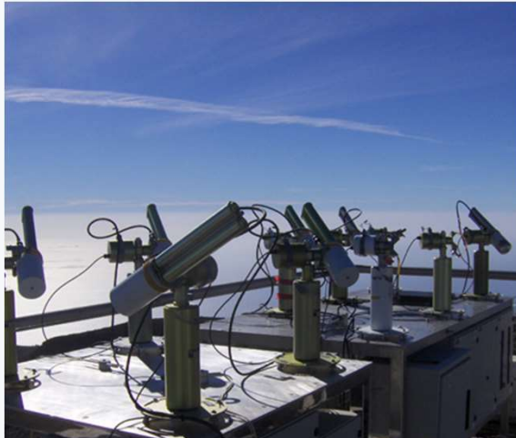
Fotómetros solares efectuando medidas de aerosoles en el observatorio atmosférico de Izaña
