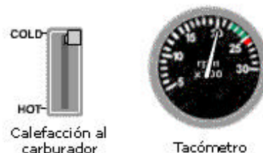
Fig.4.9.3 - Chequeo de calefacción al carburador.
