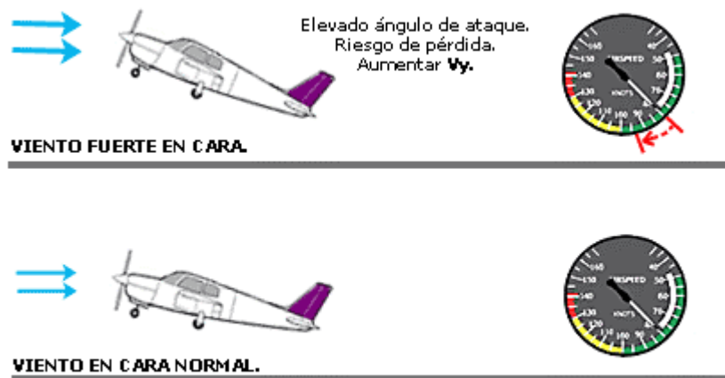
Fig.5.4.3 - Con fuerte viento en cara aumentar velocidad de ascenso.
