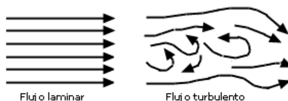
Fig.1.8.1 - Flujo laminar vs. Flujo turbulento.
