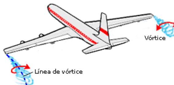
Fig.4.10.1 - Estela turbulenta (vórtices).
