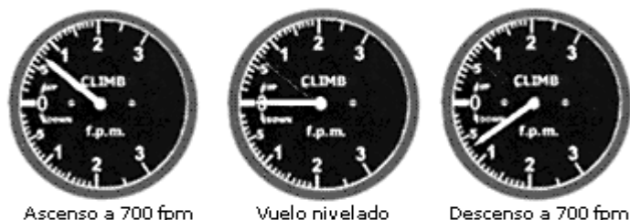
Fig.2.4.3 - Indicaciones del variómetro.
