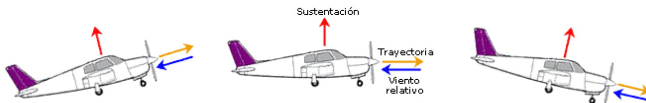
Fig.1.3.6 - La sustentación es perpendicular al viento relativo.
