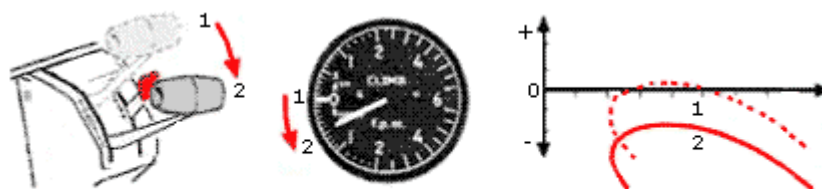
Fig.1.10.4 - Efecto de disminuir potencia (cortar gases).
