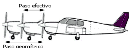
Fig.3.2.6 - Paso efectivo y paso geométrico.
