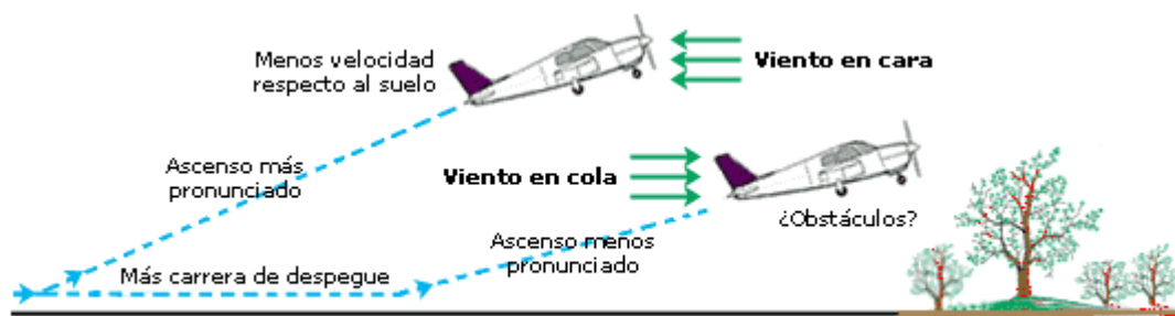
Fig.5.2.3 - Diferencias de despegue viento en cara o viento en cola.
