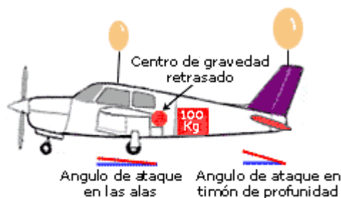
Fig.4.3.5 - Angulo de ataque excesivo en cola -decalaje negativo-
