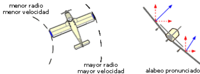
Fig.5.7.7 - Tendencia a sobrealabeo en un giro pronunciado.
