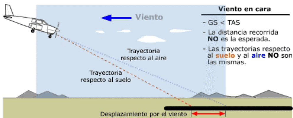
Fig.6.3.4b - Efecto del viento en la aproximación.
