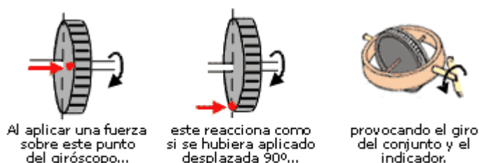
Fig.2.8.4 - Funcionamiento del indicador de viraje.
