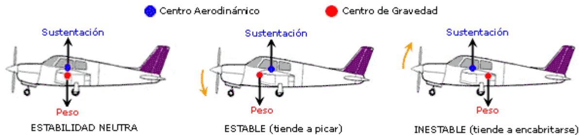
Fig.1.6.10 - Estabilidad longitudinal en función del C.A. y del C.G.
