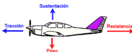
Fig.1.3.1 - Fuerzas que actúan en vuelo.
