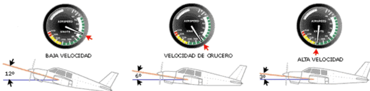
Fig.5.9.4 - Relación entre ángulo de ataque y velocidad en vuelo recto y nivelado.
