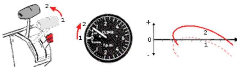
Fig.1.10.3 - Efecto de aumentar potencia (abrir gases).
