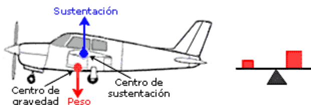
Fig.4.3.2 - Fuerzas ejercidas en un avión balanceado.
