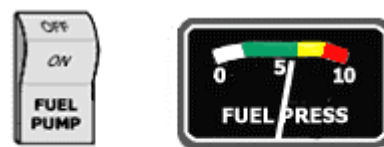
Fig.3.6.4 - Interruptor de la bomba auxiliar de combustible e indicador de presión.
