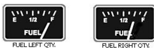
Fig.3.6.3 - Indicadores de cantidad de combustible.
