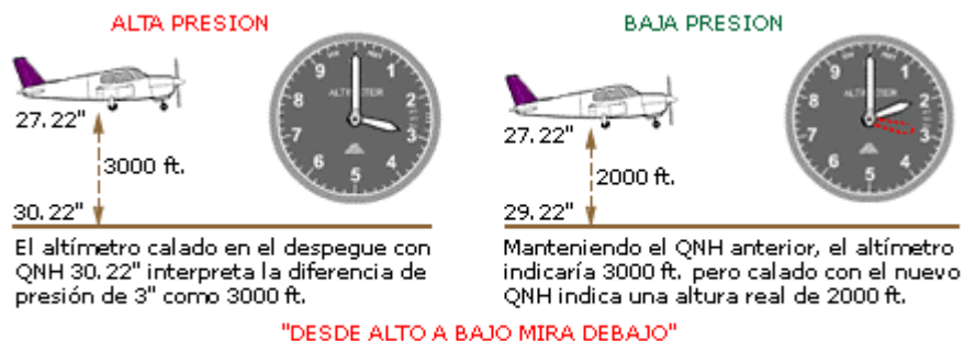
Fig.2.3.5 - Ajuste del altímetro a los cambios QNH en distintas áreas.
