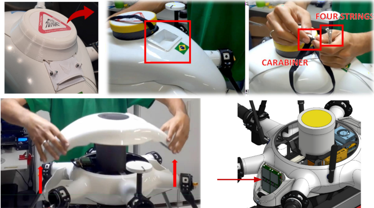
Figura 70: Intercambio de tarjeta SIM
