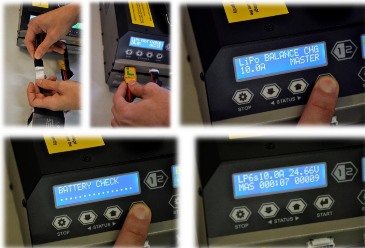
Figura 44: Carga de la batería
