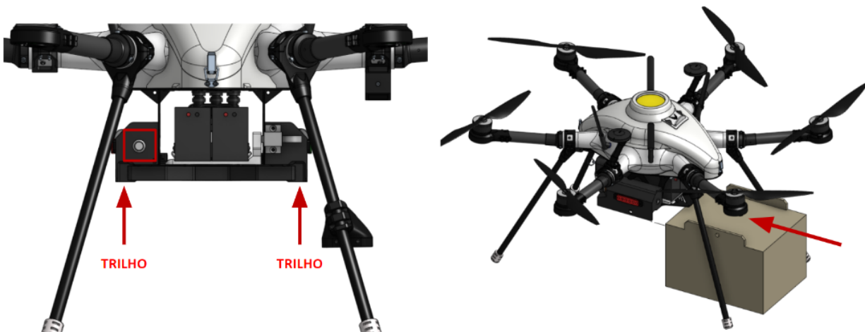
Figura 62: Colocación de la caja de carga útil
