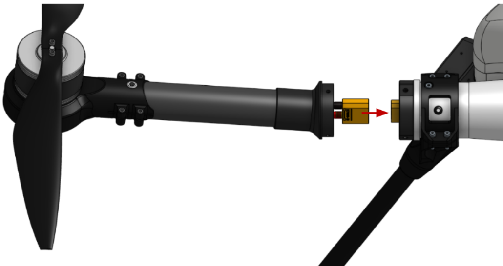
Figura 46: Montaje del brazo de propulsión - Paso 1
