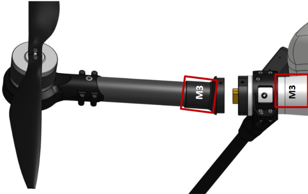
Figura 45: Identificación de la etiqueta del brazo de propulsión
